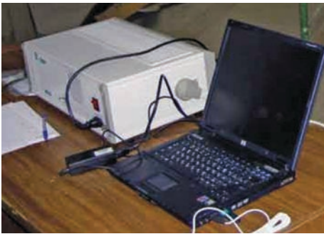
Рис. 3. Общий вид измерительного комплекса MIC-036 (а) и датчиков-акселерометров AT 1105-10м (б)
