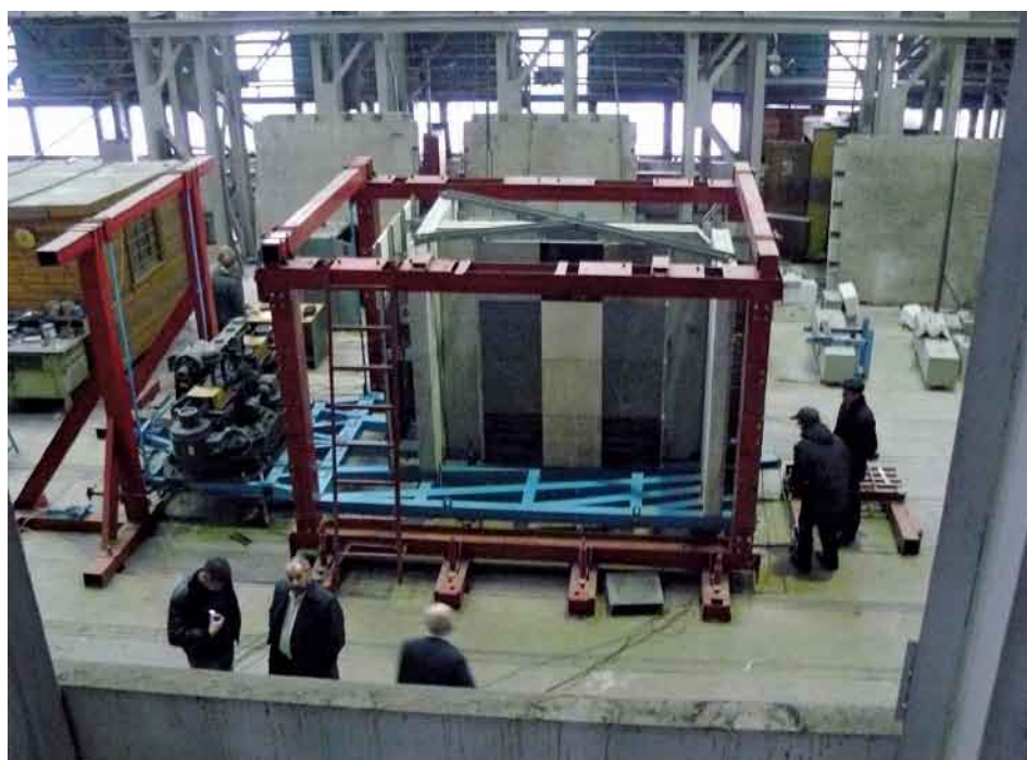
Рис. 1. Общий вид экспериментальной установки виброплатформы маятникового типа
